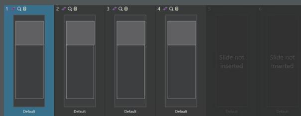
该示例显示了[画廊]视图中的托盘。此示例中的托盘可容纳 6 个载玻片。位置 5 和 6 为空。它们不包含载玻片。
