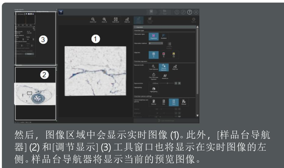
然后，图像区域中会显示实时图像 (1)。此外，[样品台导航器] (2) 和[调节显示] (3) 工具窗口也将显示在实时图像的左侧。样品台导航器将显示当前的预览图像。
