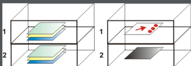
插图显示由两个层 (1) 和 (2) 组成的两个多层图像。左侧的多层图像包含两个图像层。其中每个图像层都由多通道图像组成。右侧的多层图像包含绘图层 (1) 和图像层 (2)。
