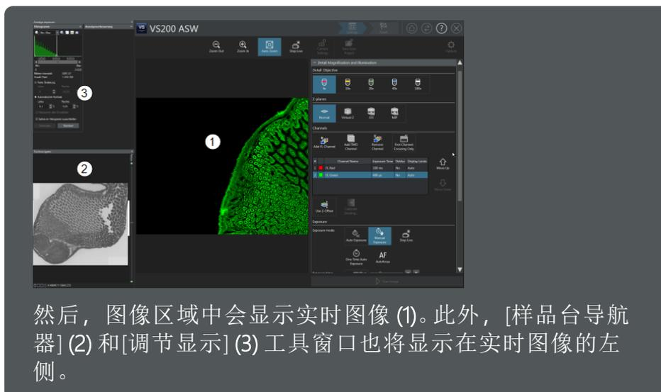
3. 请注意[调节显示]工具窗口。使用荧光观测模式来采集预览图像时，它会自动出现在图像区域左侧。
