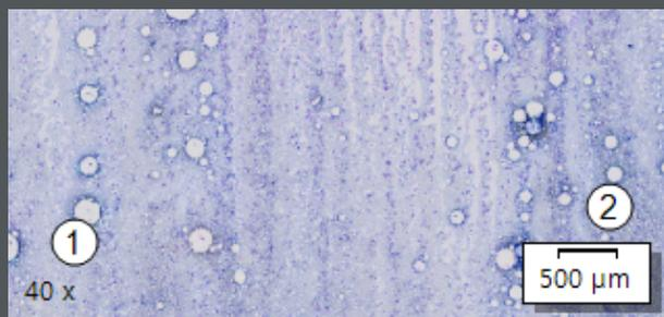
在此示例中，信息印记显示在右下角 (1)，标尺栏显示在右下角 (2)。在此示例中，信息印记显示了活动图像层的物镜放大倍率。
