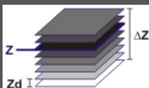
最上层和最下层 Z 平面之间的距离称为 [Z 范围]。在图示中，它被标记为  $\Delta Z$ 。Z 范围指的是 Z 轴移动的总距离。
